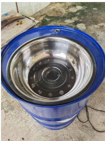
ภาพที่ 3.3 แสดงกะละมังที่เชื่อมถังน้ำมันเรียบร้อยแล้ว
