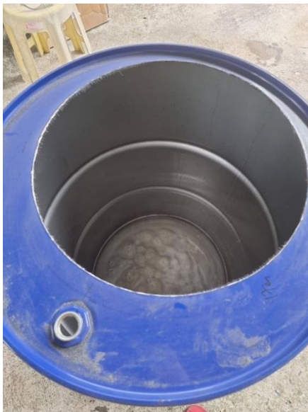
ภาพที่ 3.2 แสดงถังที่ตัดฝาถังเรียบร้อยแล้ว
