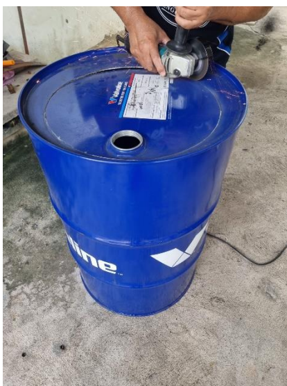
ภาพที่ 3.1 แสดงวิธีการตัดฝาถังโดยหินเจีย
